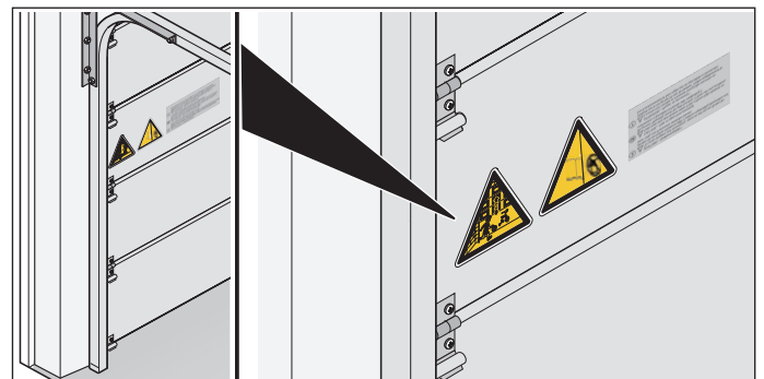
Afb. 1.2 Sticker op deurblad aanbrengen
