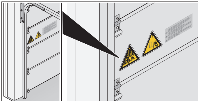
Afb. 1.2 Sticker op deurblad aanbrengen
